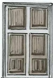
Fenêtre du XVe et XVIe siècle avec meneau (élément bâti en maçonnerie ou bois) et volets bois intérieurs
