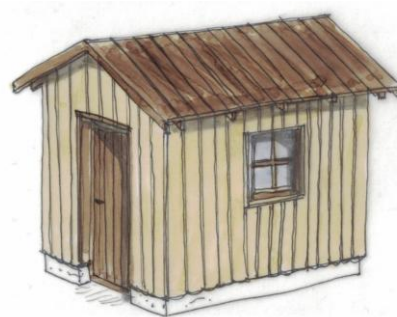
Exemple de cabane en bois traditionnelle avec soubassement maçonné (en moellons) ossature bois, barrage bois vertical avec linteau couvre-joint. Couverture en bois
