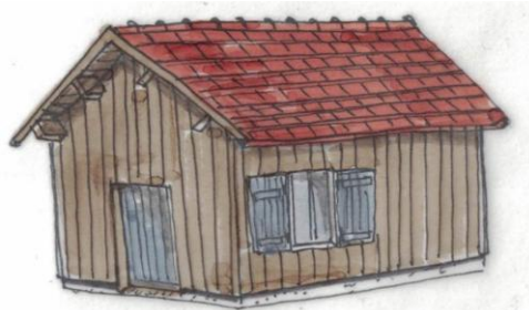
Exemple de cabane en bois traditionnelle avec soubassement maçonné (en moellons) ossature bois, barrage bois vertical, couverture en tuiles plates, faitage en tuiles à emboitement
