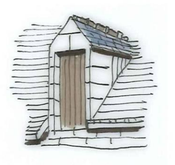
Lucarne engagée à fronton triangulaire en pierre de taille et deux pentes
