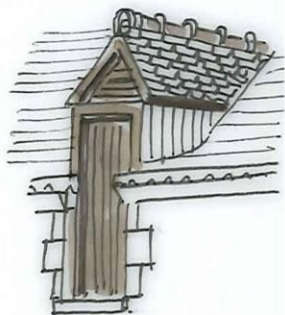
Lucarne pendante à deux pans, fronton bois et jouées en bardage bois
