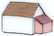
Extensions en appentis contre le pignon (léger décroché)
