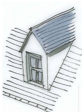
Lucarne dite jacobine à deux pentes (maçonnée et enduite) dite « jacobine » ou « en bâtière »
