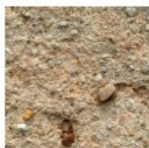
Sable ocre roux en enduit de finition (Courvaux)
