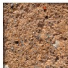
Sable ocre roux en enduit de finition (Etableau)
